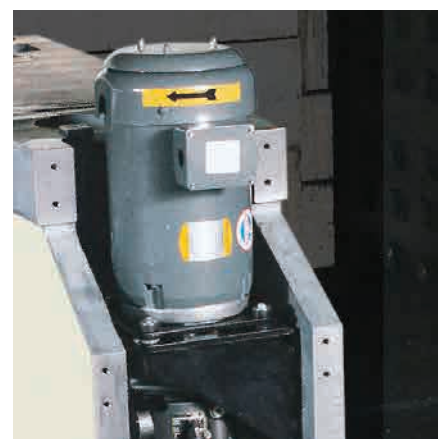
油圧モータポンプ部はベッド脚部左後面に取り付けられています。
